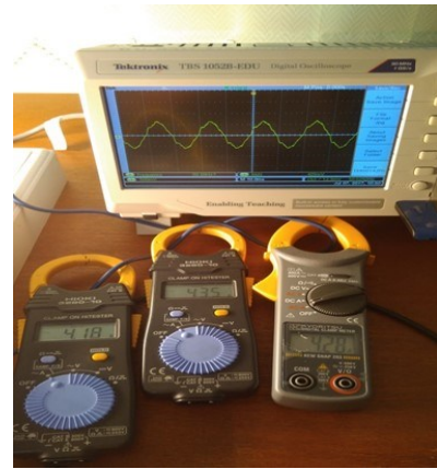
ภาพที่ 9: แสดงการวัดกระแสที่โหลดหลอดไฟ 1000 W
