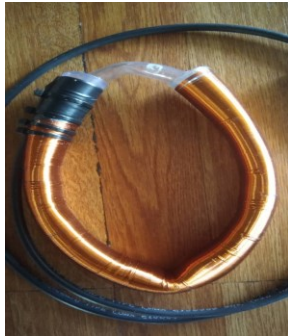
ภาพที่ 3: การพันขดลวด โรกอฟสกีคอล์ยด์
