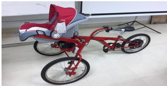
ภาพที่ 4 รถเข็นเด็กไฟฟ้าแบบพับได้เสร็จสมบูรณ์
