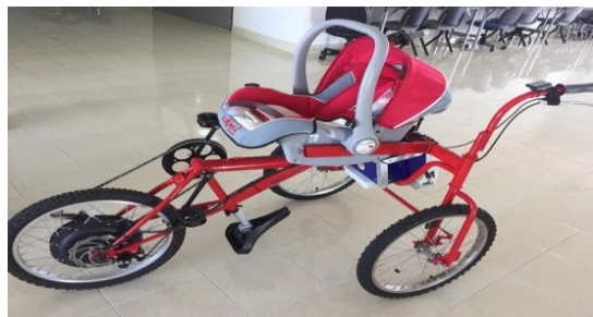
ภาพที่ 5 รถเข็นเด็กไฟฟ้าแบบพับได้เสร็จสมบูรณ์
