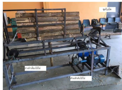
ภาพที่ 3 : เครื่องผ่าซีกไม้ไผ่ต้นแบบ
