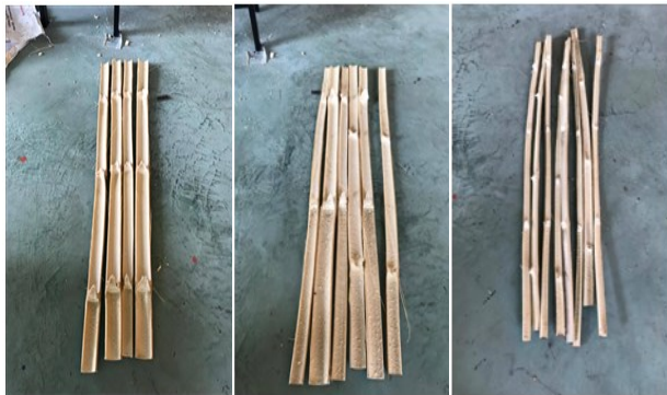
ภาพที่ 8 : ไม้ไผ่ที่ได้จากเครื่องที่ใช้ชุดใบมีด ผ้า 4 และ 8 ซีก
