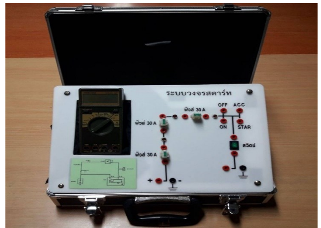
ภาพที่ 3: แสดงชิ้นงานของผู้เรียน โดยการใช้โครงงานเป็นฐานวงจรสตาร์ทเครื่องยนต์
