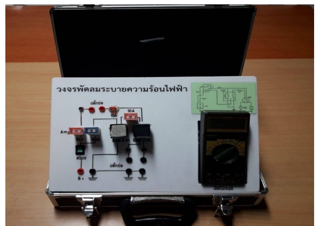
ภาพที่ 4: แสดงชิ้นงานของผู้เรียน โดยการใช้โครงงานเป็นฐานวงจรควบคุมพัดลม
