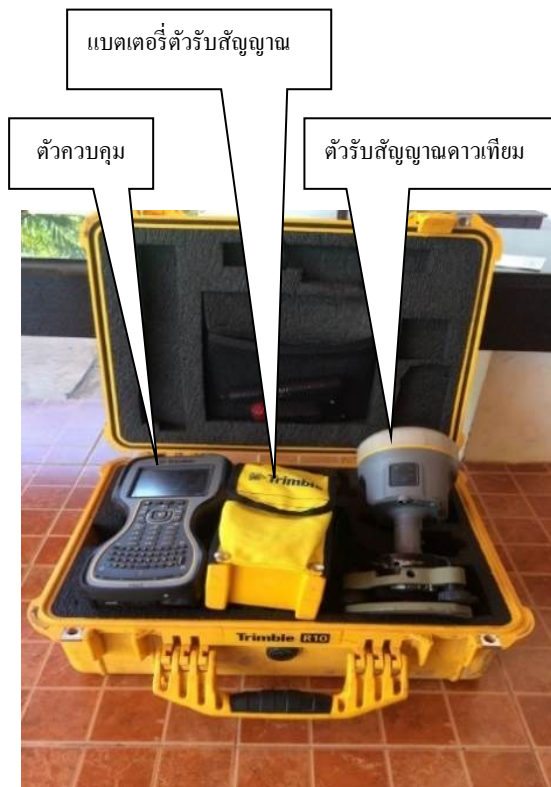
ภาพที่ 2 แสดงอุปกรณ์ GNSS รุ่น Trimble R10
