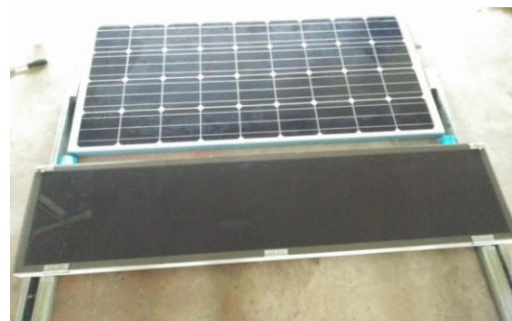
ภาพที่ 13 เซลล์แสงอาทิตย์ ขนาด 160W ติดตั้งกับชุดป้าย LED
