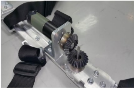
ภาพที่ 3 : จุดที่เฟืองขบกันของเครื่องมือ
