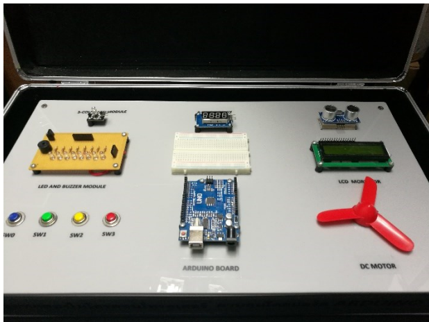
ภาพที่ 3. บอร์ดทดลองไมโครคอนโทรลเลอร์เบื้องต้น
