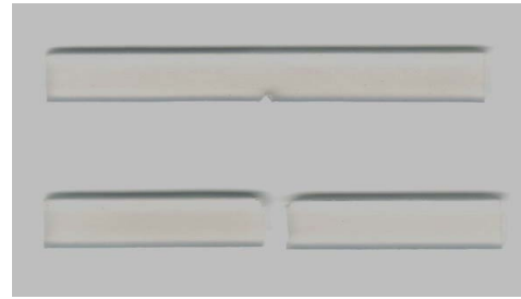
ภาพที่ 15 : การเสียหายจากการทดสอบแรงกระแทกโพลีโพรพิลีนบริสุทธิ์
