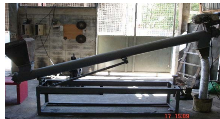
ภาพที่ 2 แสดงรูปอุปกรณ์ทดลองชุดสกรูลำเลียงสามารถปรับมุมในการขนถ่ายได้ 15,30,45 องศา
