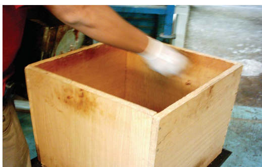
ภาพที่ 8 : การโรยหญ้าแฝกที่ผ่านการคลุกผสมลงในกล่องอัด
