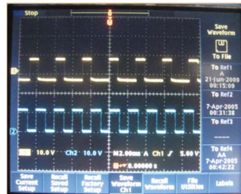
ภาพที่ 4: สัญญาณ PWM จากการทดลอง
