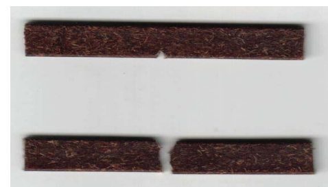
ภาพที่ 16: ความเสียหายจากการทดสอบแรงกระแทกโพลีโพรพิลีนผสมเส้นใยธรรมชาติ
