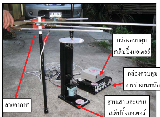
ภาพที่ 1 : โครงสร้างเครื่องดักจับสัญญาณคลื่น
