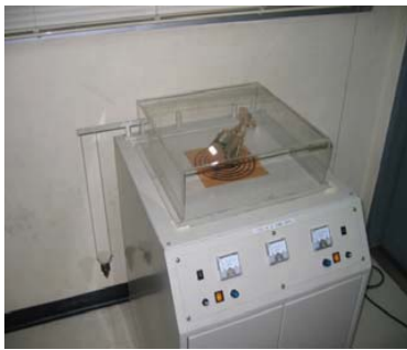
ภาพที่ 5: ชุดทดลองพร้อมครอบป้องกันและแขนสำหรับแขวนมอเตอร์เพื่อหาค่าโมเมนต์ความเฉื่อย
