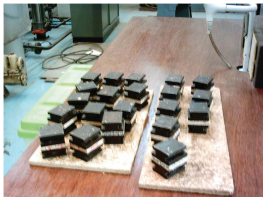
ภาพที่ 13 : ตัวอย่างก่อนทำการทดสอบหาค่าแรงยึดเหนี่ยวภายใน
