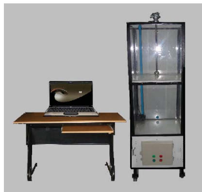
ภาพที่ 2 ชุดสาธิตการวัดและควบคุมระดับของเหลว
