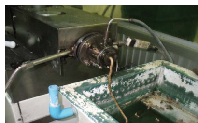
ภาพที่ 6: ส่วนผสมที่ออกมาจากเครื่อง Twin Screw Extruder
