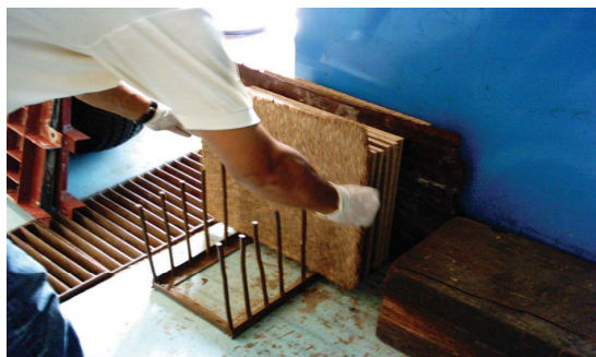
ภาพที่ 11 : การพักแผ่นหญ้าแฝกเพื่อปรับสภาพเพื่อให้แผ่นคลายความร้อนและหดตัว
