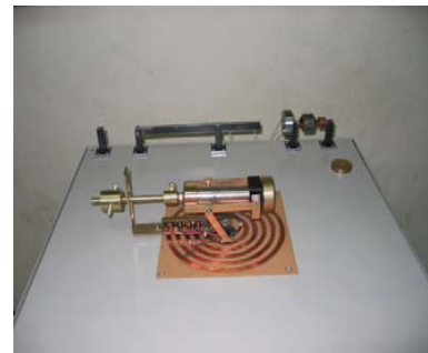
ภาพที่ 8: แผ่นลายปริ้นท์ทองแดงหน้าสัมผัสกับแปลงถ่าน
