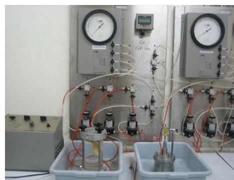
ภาพที่ 4-4 เครื่องทดสอบที่ประกอบกับเครื่องควบคุมแรงดันอากาศ
