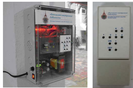
ภาพที่ 4 : เครื่องควบคุมแสงสว่างหลอดฟลูออเรสเซนต์ด้วยรีโมทคอนโทรลที่สร้างขึ้น
