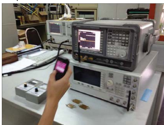
ภาพที่ 11 การทดสอบเครื่องมือวัดที่พัฒนาขึ้นเปรียบเทียบกับเครื่องวิเคราะห์แถบความถี่ (Spectrum Analyzer)
