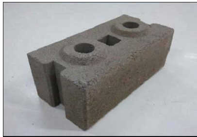
ภาพที่ 5 : ภาพแสดงบล็อกประสานที่ผลิตจากทรายบก ที่อัตราส่วน ทรายบก 100% : ลูกรีง 0 %
