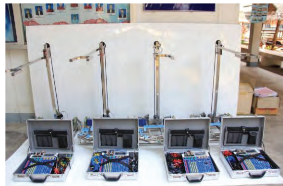
ภาพที่ 8 : ชุดทดลองวิชาโปรแกรมเมเบิลลอจิกคอนโทรลเลอร์
