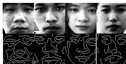
ภาพที่ 2 ภาพที่ได้จากการหาขอบด้วยวิธีของ Canny
