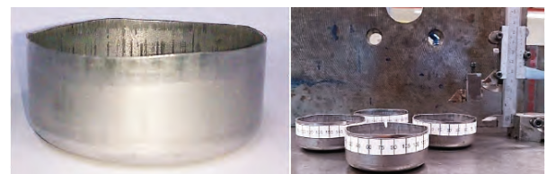
ภาพที่ 9 ชิ้นงานที่ผ่านการดึงขึ้นรูปลึกและการวัดความสูงด้วยทรงกระบอกกลม
