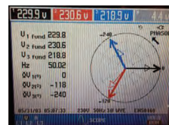
ภาพที่ 9 : เฟสเซอร์ของโหลดหลังปรับแก้ค่าเพาเวอร์แฟคเตอร์
