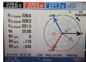
ภาพที่ 8 : เฟสเซอร์ของโหลดก่อนปรับแก้ค่าเพาเวอร์แฟคเตอร์
