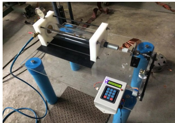
ภาพที่ 1 : ชุดทดสอบอิเล็กโทรดปรับระยะด้วยไมโครคอนโทรลเลอร์
