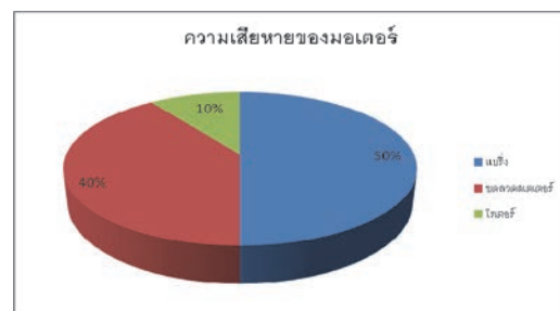
ภาพที่ 1 ความเสียหายที่เกิดขึ้นกับมอเตอร์
