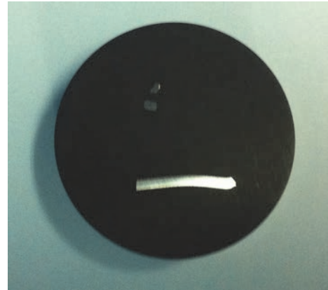
ภาพที่ 4 การขีดโครงสร้างทองแดงของสายอากาศ X-pole
