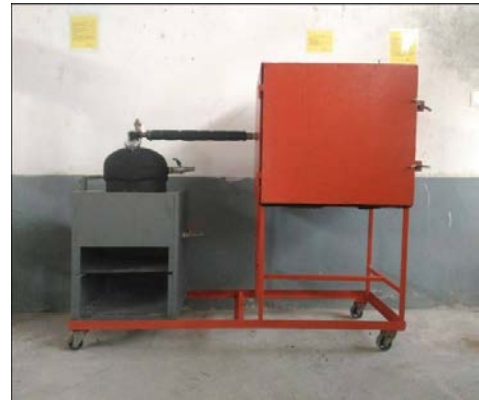
ภาพที่ 3 : หม้อต้มและตู้ที่เสร็จสมบูรณ์
