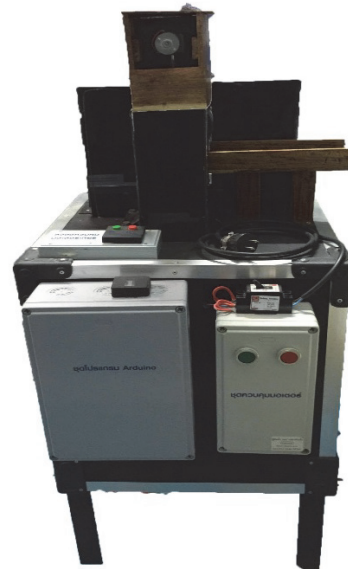
ภาพที่ 5 เครื่องรีดลีนแคนควบคุมอัตโนมัติด้วย ไมโครคอนโทรลเลอร์ Arduino
